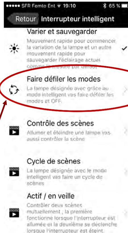
« Faire défiler les modes » permet d'enregistrer jusqu'à 4 modes + OFF et les faire défiler grâce à l'interrupteur de la pièce. Chaque « allumer et éteindre » rapide sur l'interrupteur va faire défiler les modes enregistrés.
